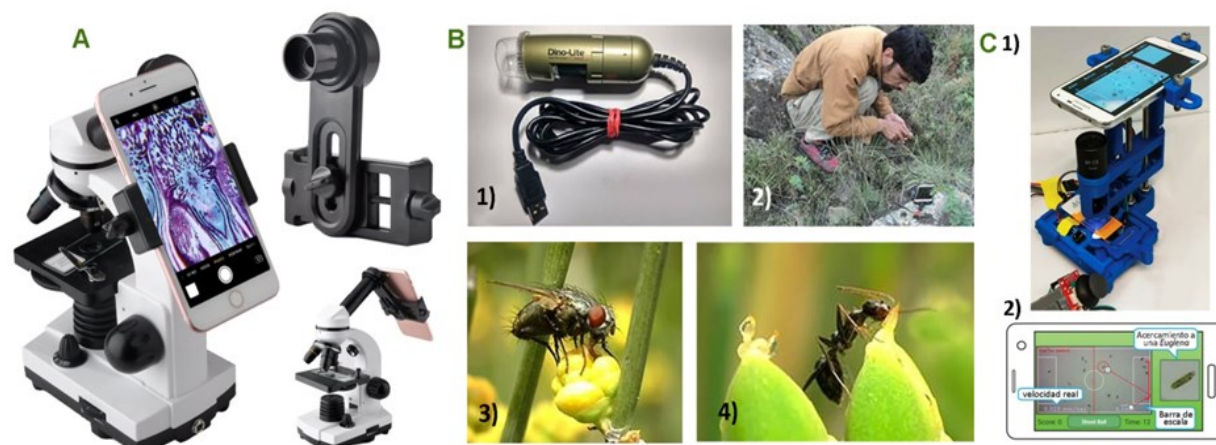
Figura 1. A) Muestra de adaptadores de teléfonos celulares para microscopios; B) microscopio portable conectable a dispositivos móviles: 1) microscopio USB, 2) uso en el campo, 3 y 4) muestra de imágenes (tomado de Rather et al. , 2019) y C) Ludoscopio: 1) Vista del dispositivo ensamblado y 2) pantalla del teléfono con la aplicación del juego (tomado de Kim et al. , 2016).
