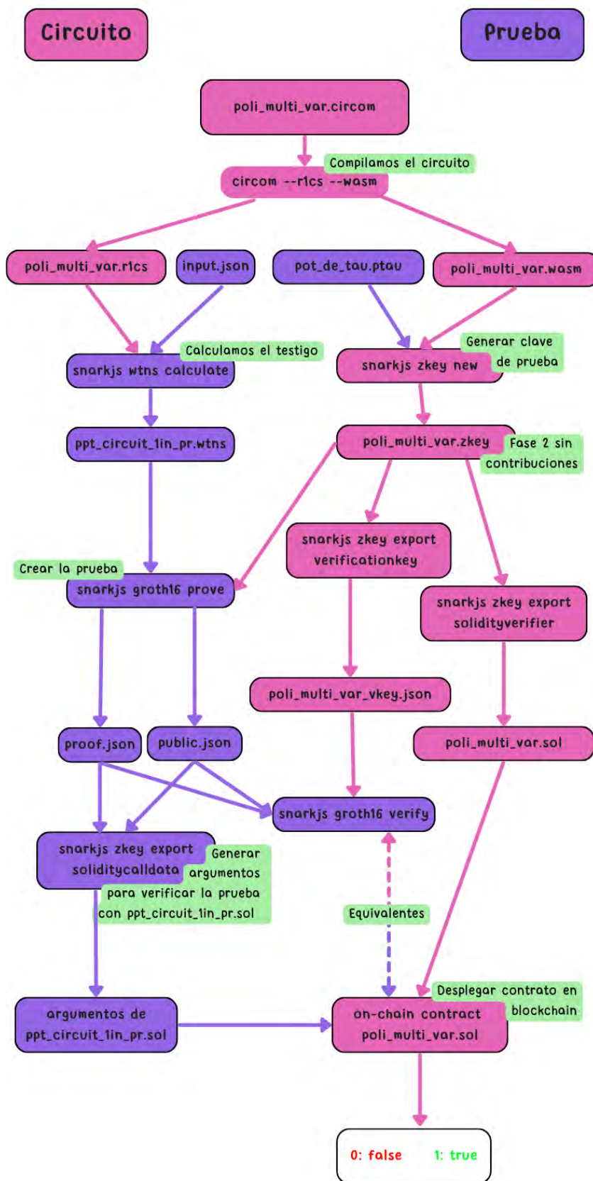
Figura 7. Flujo para generar y verificar una prueba zk-SNARK con Circom y snarkjs para la plantilla de circuito PoliMultiVar() [Flow to generate and verify a zk-SNARK proof with Circom and snarkjs for the PoliMultiVar() circuit template].
