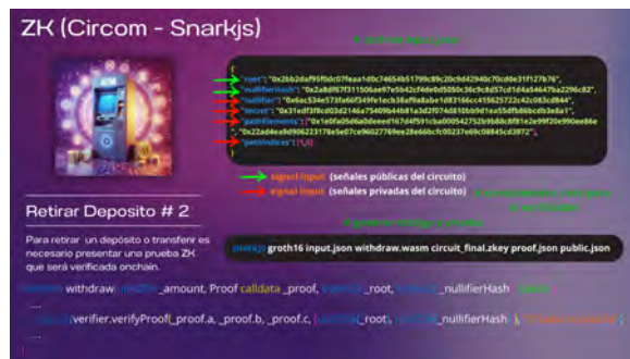
Figura 21. Flujo de trabajo de generación y verificación de pruebas zk-SNARK en ZKATM [Workflow for generating and verifying zk-SNARK proofs in ZKATM].
