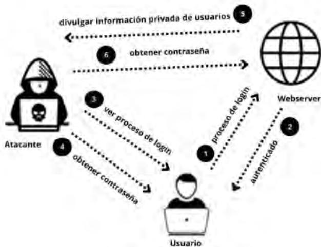
Figura 1. Un atacante observa el proceso de autenticación o intercambio de datos, los datos pueden ser filtrados [An attacker observes the authentication process or data exchange, data can be leaked.].
