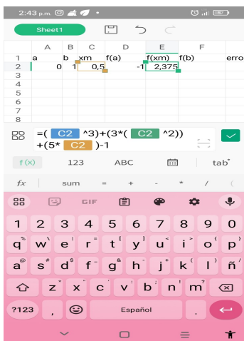
Figura 5. Programaciones en WPS Office (Excel del móvil) aplicando el método de bisección [Programmings in WPS Office (Excel) applying the method of bisection].
