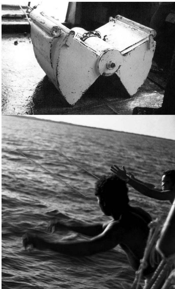
Fig. 2 - Métodos de muestreo de la seiba en la plataforma noroccidental. A - Jaiba "Okean" (40 kg de peso); B - El marco de 1 m 2 (SF) es lanzado al mar para el buceo SCUBA.
