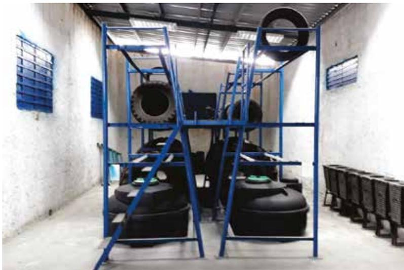
**Fig. 3.7.** Estantería especializada para neumáticos del tipo “Limonar”.
