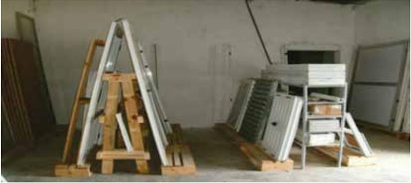
**Fig. 2.5.** Estiba directa flexible, auxiliada por burros o estanterías para fraccionada apoyado el producto sobre plataformas de carga.
