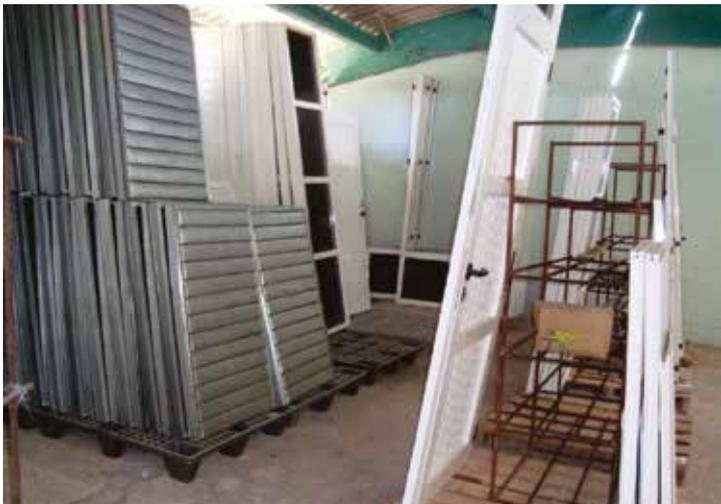
**Fig. 2.6.** Estiba directa flexible auxiliada por estanterías para carga fraccionada montadas sobre paletas al igual que el producto.
