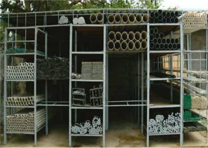
**Fig. 2.14.** Cunitas tecnológicas entre estanterías utilizada para cargas largas y como nave autoportante.
