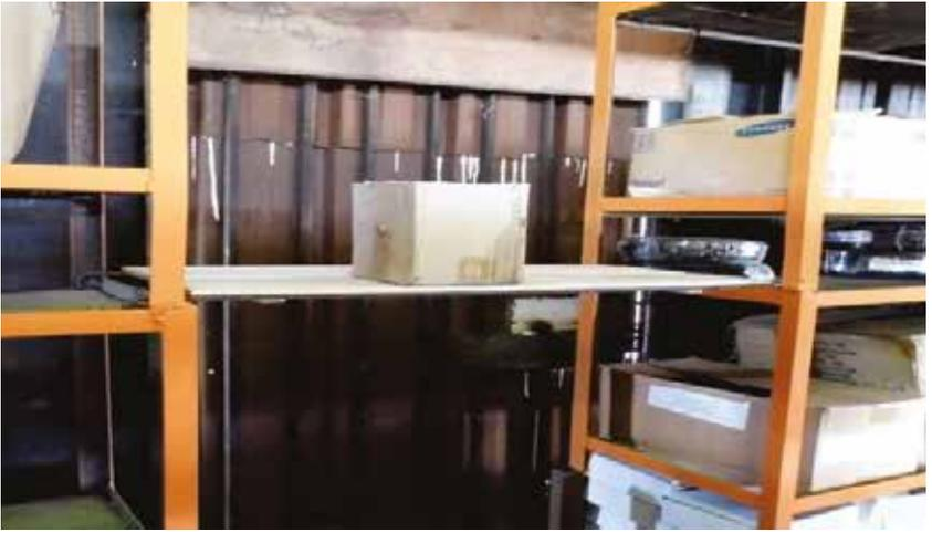
**Fig. 2.12.** Cunita tecnológica entre estanterías para carga fraccionada.
