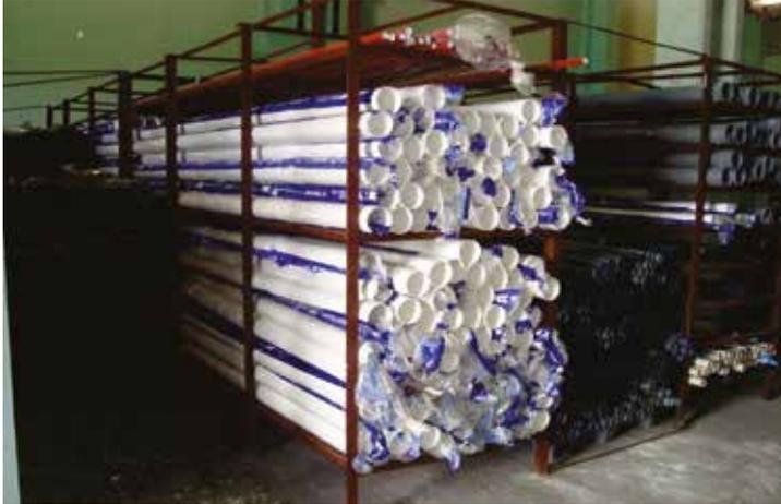
**Fig. 2.3.** Cenefa tecnológica utilizada para tuberías plásticas, manipulación manual.
