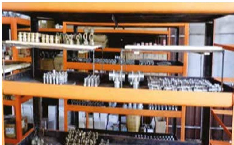
**Fig. 2.21.** Aditamento para incrementar la capacidad de almacenamiento en estantería para carga fraccionada.
