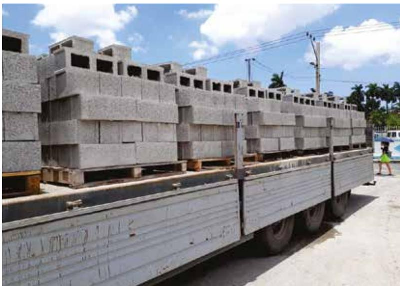
**Fig. 3.8.** Transportación de bloques unitarizados sobre paletas.
