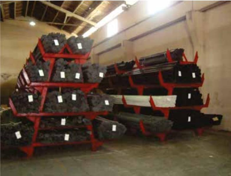
**Fig. 1.3.** Estanteria especializada para cargas largas utilizada con cargas ligeras, manipulación manual.
