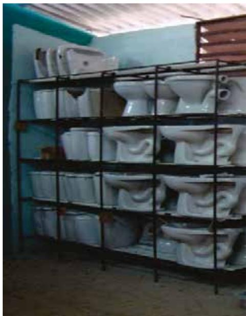
**Fig. 2.18.** Estantería convencional para carga fraccionada utilizada como una estantería especializada sin modificar para muebles sanitarios.
