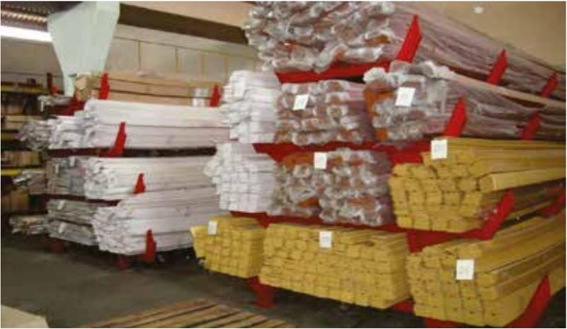
**Fig. 1.4.** Estantería especializada utiliza para el almacenamiento de madera y otras cargas largas, manipulación manual.
