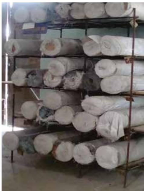
**Fig. 2.17.** Estantería convencional para carga fraccionada utilizada como una estantería especializada para cargas cilíndricas (rollos de lijas).
