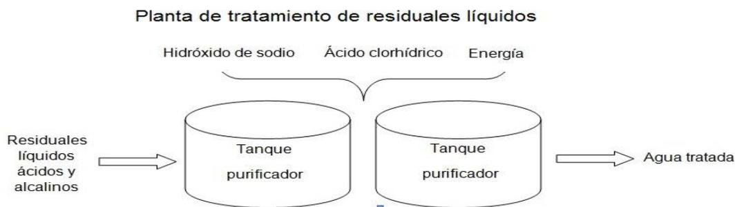
Figura 3.2: Proceso de apoyo medioambiental. Tratamiento de aguas residuales
